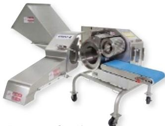
Pour une hygiène optimale, la zone de coupe est entièrement isolée des composants mécaniques, châssis tubulaires et surfaces inclinées.
